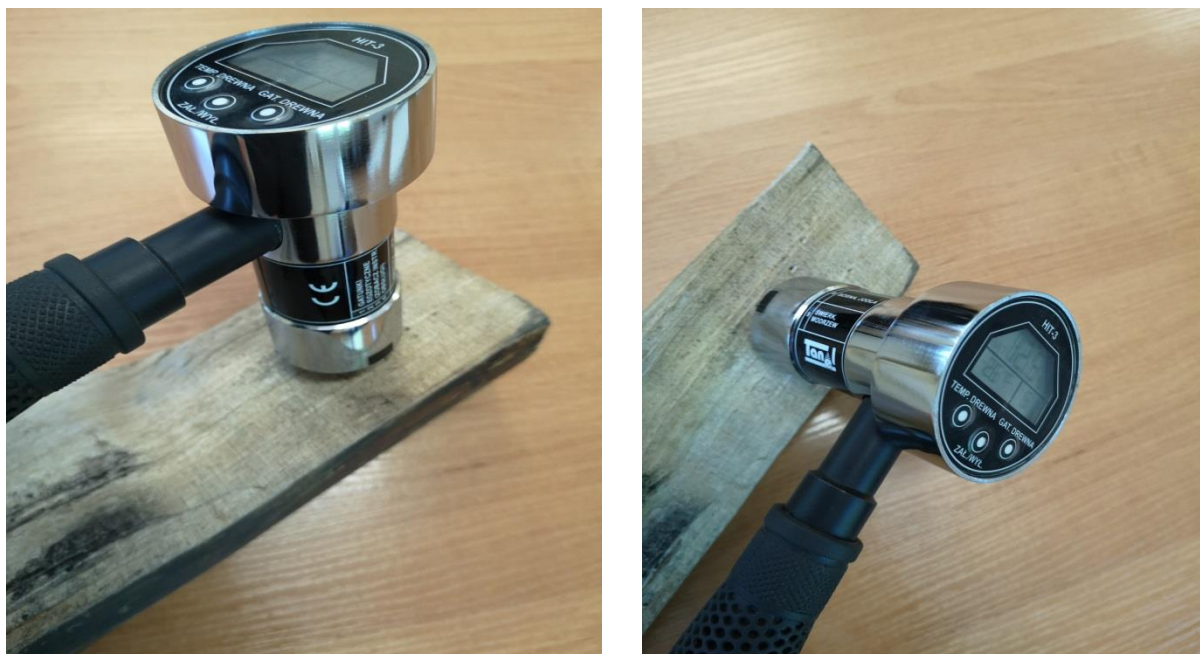
Rys. 2 Pomiar wilgotności drewna wilgotnościomierzem rezystancyjnym.
